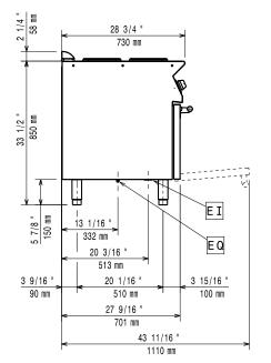
Electrical inlet (power) EQ **Equipotential** screw
